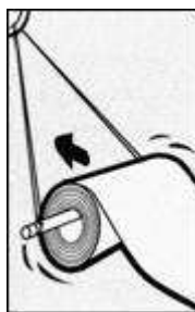
Rys. 3. Ułożenie siatki – rolka siatki umocowana na wysięgniku pojazdu
